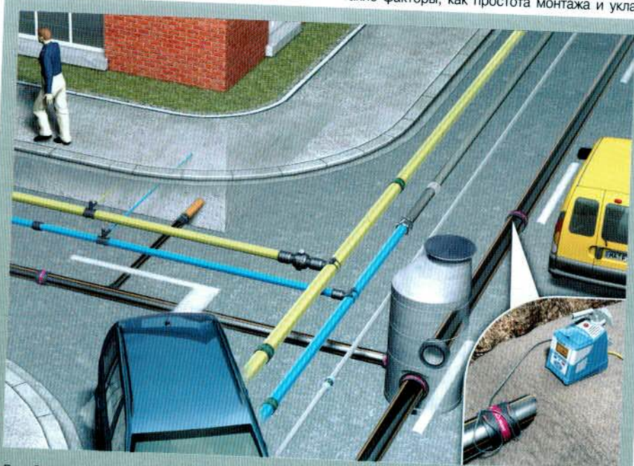
Рис. 3. Данный пример подземной инфраструктуры иллюстрирует применение полиэтиленовых труб в областях газо- и водоснабжения, защиты кабелей и коммуникаций, а также, естественно, канализации.
